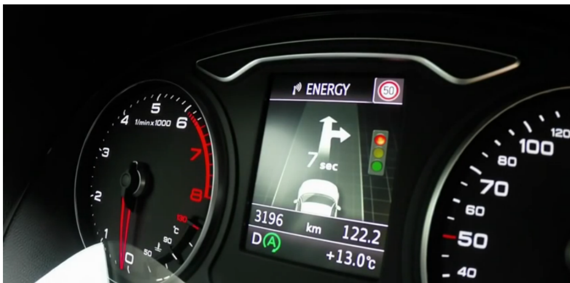
Figuur 3 Voorbeeld Use Case Informeren in-car, in beeld zijn maximale snelheid, status verkeerslicht en Tijd tot groen
