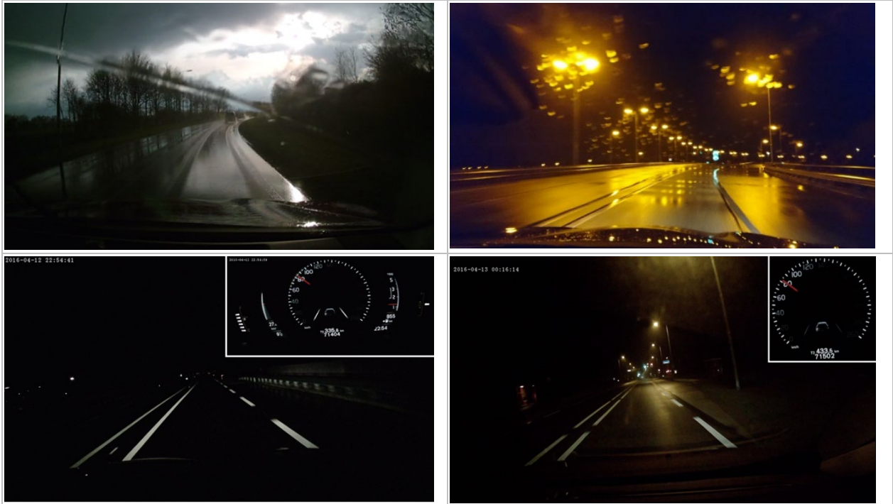
Figuur 8. LKA systemen functioneren minder goed bij duisternis en nat wegdek, impressie
