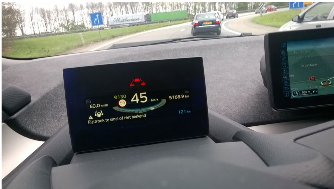
Figuur 9. Functioneren van LKA systemen in bogen en smalle rijstroken
