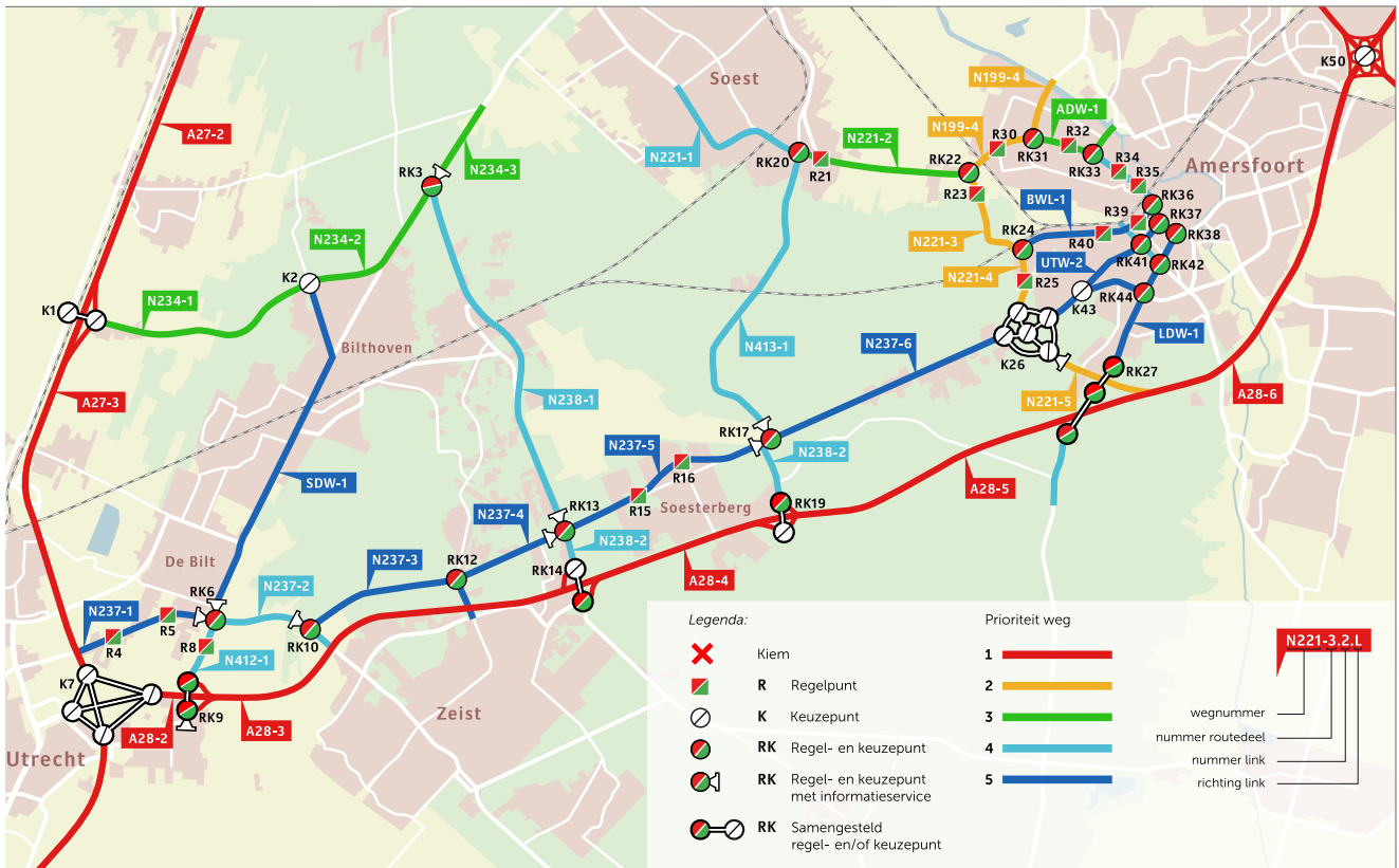
Figuur 5. Voorbeeld van identificatie van routedelen en overzicht bij uitwerking blokkade onderliggend wegennet
